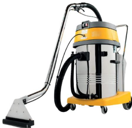
Lavamoquette carrellato dotato di 2 motori con presenza di termostato protezione pompa e comando indipendente di azionamento. La versione Auto, per il settore automotive e carwash, è dotata della sola bocchetta manuale e del tubo estrazione 6m Ø 40.
